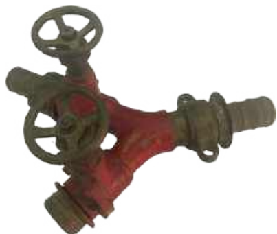
12. RAZDJELNICA Ivanić-Grad, DVD Ivanić-Grad, mjed, duž. 47 cm, šir. 35 cm Mjedena crvena razdjelnica s dva ventila. pr. pol. 20. st.
