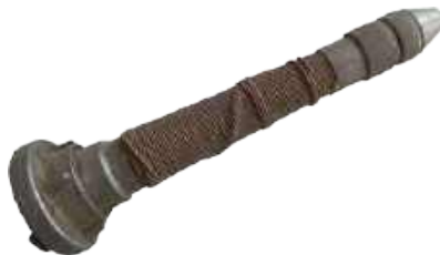
127. MLAZNICA Posavski Bregi, DVD Posavski Bregi, metal, konac, duž. 37 cm, pro. 10 cm Metalna C mlaznica omotana užetom od prirodnih materijala. pol. 20. st.
