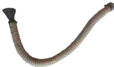
192. USISNA CIJEV I KOŠARA Deanovec, DVD Deanovec, tkanina, metal, guma, duž. 172 cm Usisna košara i usisna cijev. kraj 20.st.
