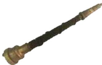
6. C MLAZNICA Ivanić-Grad, DVD Ivanić-Grad, mjed, konac, duž. 59 cm, pro. 9 cm Mjedena C mlaznica obložena užetom od prirodnih materijala. poč. 20. st.
