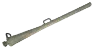
15. MLAZNICA ZA PJENU Ivanić-Grad, DVD Ivanić-Grad, aluminij, željezo, duž. 180 cm, šir. 24 cm Mlaznica za pjenu. pol. 20. st.
