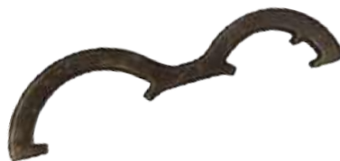
169. DVOSTRANI KLJUČ Trebovec, DVD Trebovec, željezo, duž. 41 cm i šir. 10 cm Dvostrani željezni vatrogasni ključ za spajanje cijevi. Jedna strana služi za spajanje B, a druga strana A spojnica usisnih cijevi. pol. 20. st.
